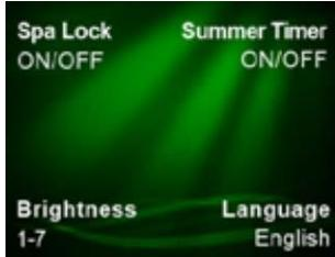
Želite li promijeniti bistrinu ekrana na glavnoj upravljačkoj ploči, pritisnite "tvrdnu" tipku OPTIONS i "mekanu" tipku Set Up da biste dobili prikaz ka onaslici lijevo.
