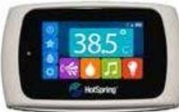
Hotspring bežični LCD upravljač nudi višebojni LCD ekran osjetljiv na dodir sa svim funkcijama bazena, bežičnu komunikaciju s upravljačkim sustavom bazenata bežično punjenje preko ležišta punjača.
