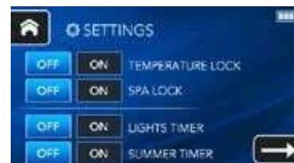
Prvi prikaz u ovom izborniku omogućava Temperature Lock (zaključavanje temperature), Spa Lock (zaključavanje bazena), Lights Timer (timer rasvjete) i Summer Timer on/off (ljetni režim rada).
