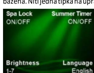
Za aktivaciju SPA LOCK opcije potrebno je pritisnuti OPTIONS "tvrdi" tipku iz tim SET UP "mekanu" tipku. Pojavit će se prikaz ekrana na slici lijevo. Za aktivaciju SPA LOCK opcije pritisnite SPA LOCK "mekanu" tipku.
