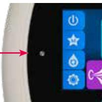
Pritisnite ako je ikona zatamnjena kako bi aktivirali opciju. Senzor (lociran na lijevoj strani daljinskog) će automatski podešiti svjetlinu ekrana s obzirom na vanjsko osvjetljenje.
